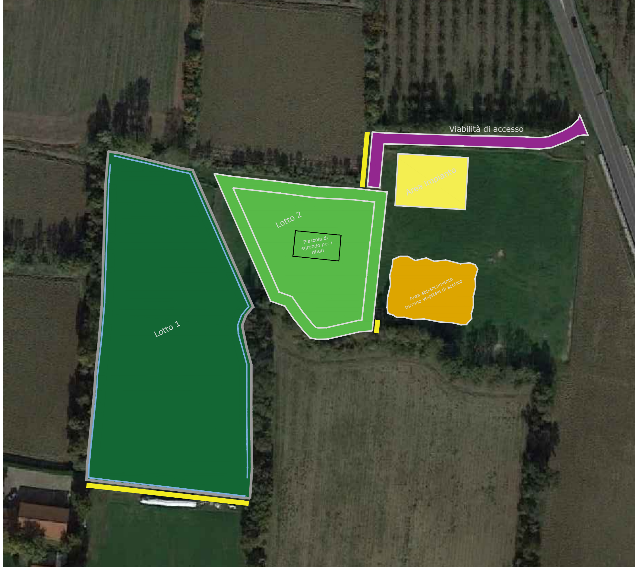
FASE 8 - Scotico sul Lotto 2 e allestimento piazzola di sgrondo rifiuti
