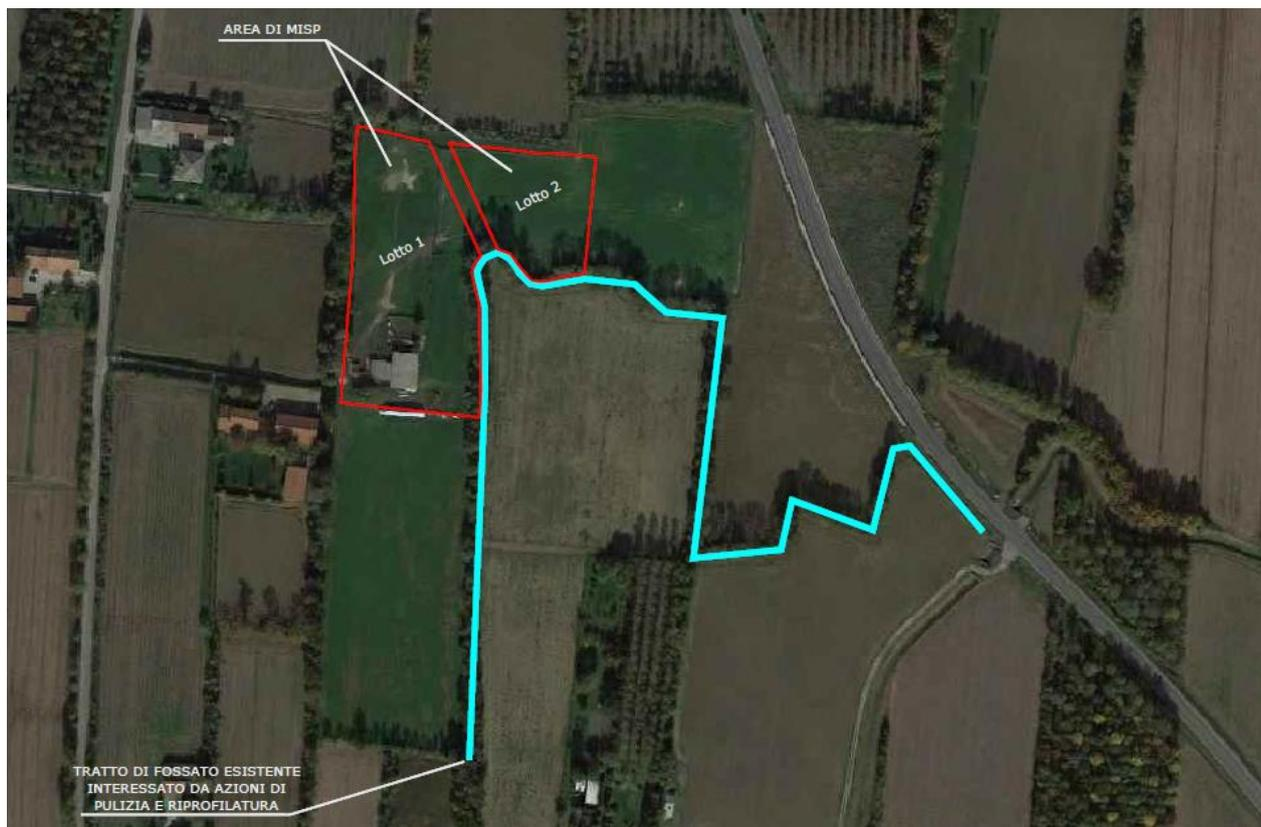
Figura 12: Individuazione del tratto di fossato esistente interessato da azioni di pulizia e riprofilatura.
