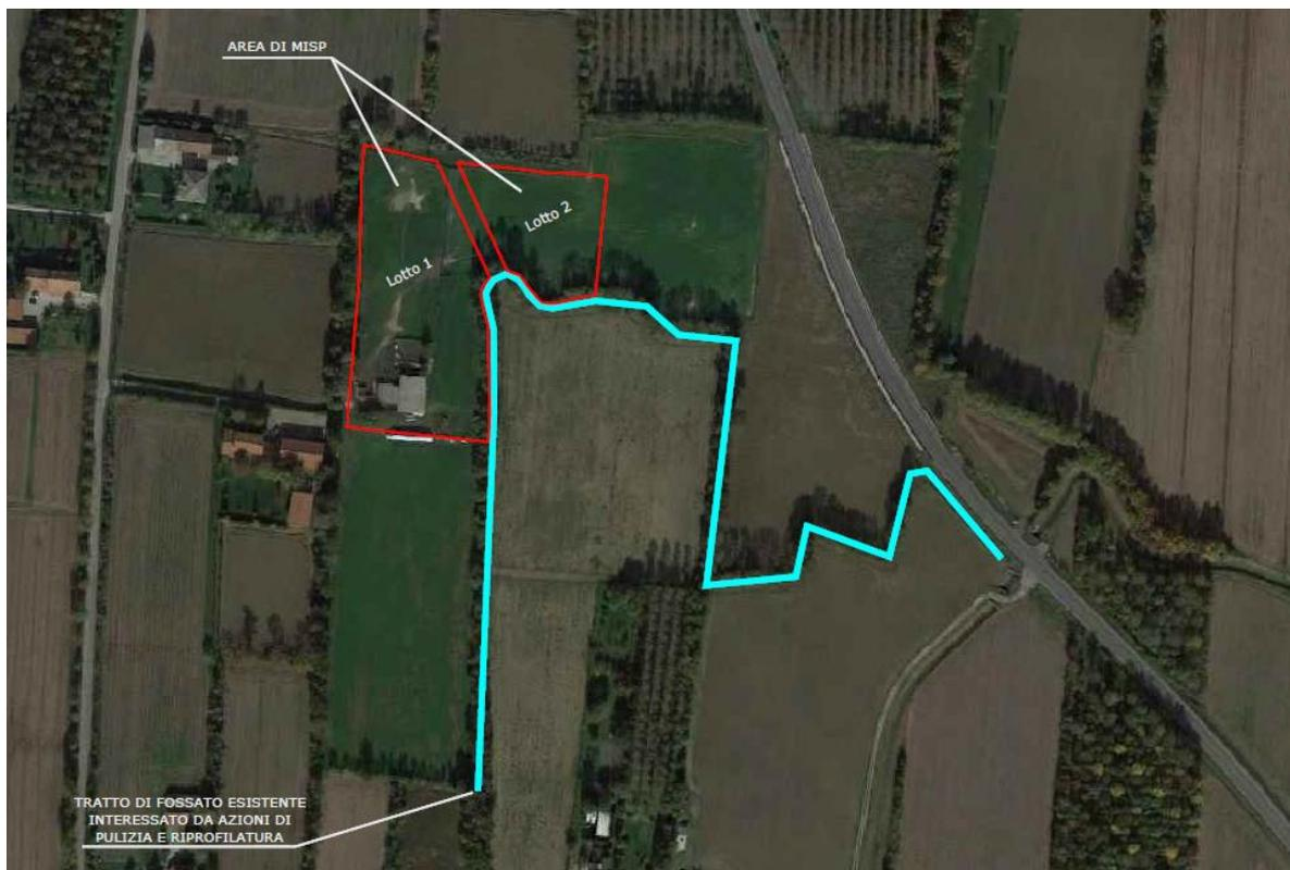
Figura 16: Individuazione del tratto di fossato esistente interessato da azioni di pulizia e riprofilatura.
